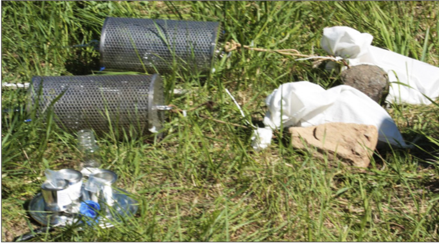
Am 2. Juni 2017 werden die Metallbehälter mit den so genannten Passivsammlern an vier Positionen im Trottheidensee befestigt.
